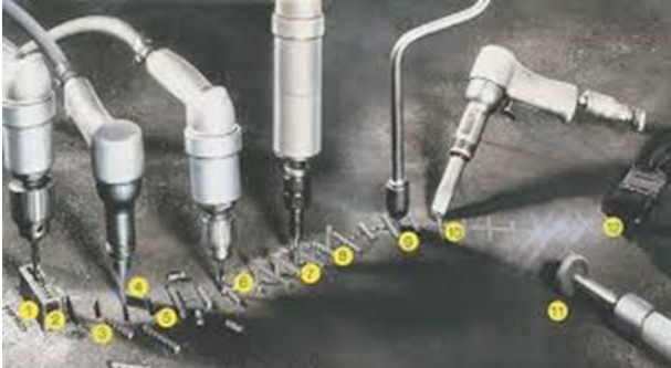
Figuur 16 Repareren van gietijzer met behulp van krammen
