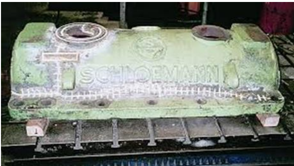
Figuur 17 Repareren van gietijzer met behulp van krammen
