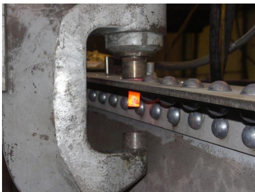
Figuur 9 Apparatuur voor het aanbrengen van zwaardere klinknagels
