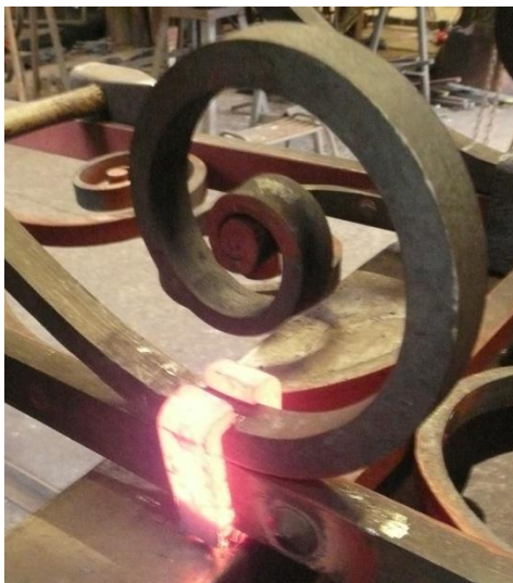
Figuur 8 maken van een strop
